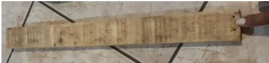
Figura 2.3 – Imagem fotográfica indicando o local para fazer os furos na madeira antes de parafusar. Ripa de 50 cm.
