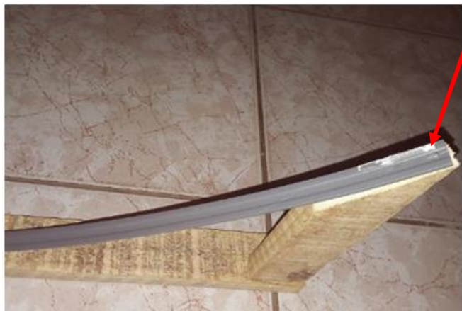
Figura 2.8 – Imagem fotográfica indicando a fixação da junta de dilatação de PVC na haste vertical (extremidade mais baixa, a de 20 cm) da base de madeira, ponto indicado pela seta em vermelho.
